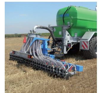
Einbring-Schlitzgerät Innovative Ausbringtechnik
